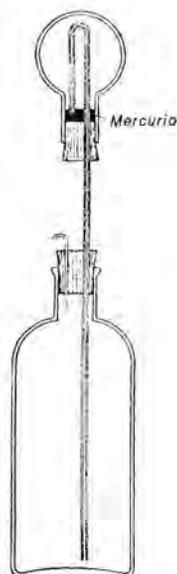
FIG. 165. Atmómetro de LIVINGSTON-THONE, representación simplificada.
